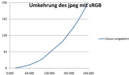
Abb. 10 Umkehrfunktion für Kamera-JPG zur Kompensation der Gammakurve
